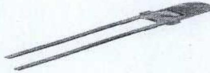
Gambar 1. Photodiode (ryankudeta.wordpress.com)
